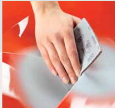
Füller-Endschliff von schwer zugänglichen Stellen
