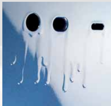
Entfernen von Lackläufern
