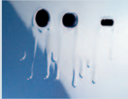
Eliminación de descolgado de pintura
