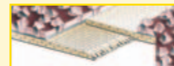
Type 3 bandverbinding twee uiteinden verbonden met speciale film aan rugzijde
