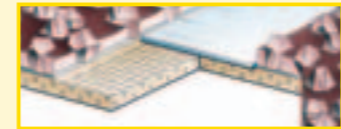
Type 3 bandverbinding twee uiteinden verbonden met speciale film aan rugzijde
