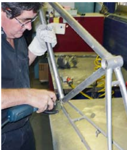
Verputzarbeiten und Kontrolle eines individuell hergestellten Rahmens
