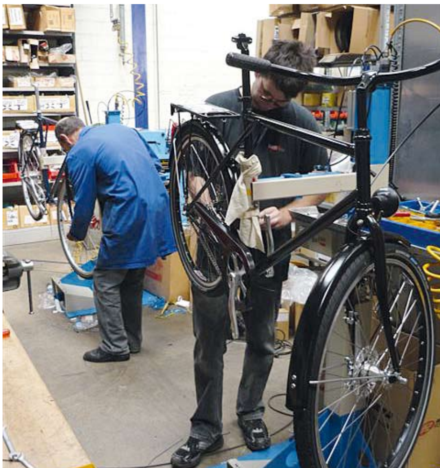
Montage von Industrierädern, die den Ansprüchen des Kunden gerecht werden
