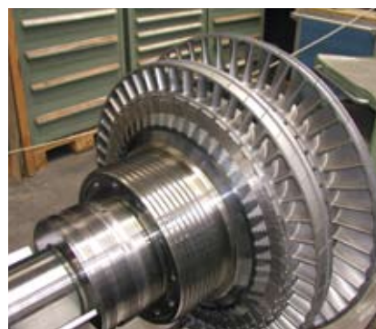
Die einzelnen Turbinenschaufeln fertig montiert
