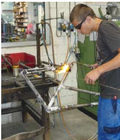
Lötarbeiten an hochwertigem 25cr-mo4-Stahlrahmen
