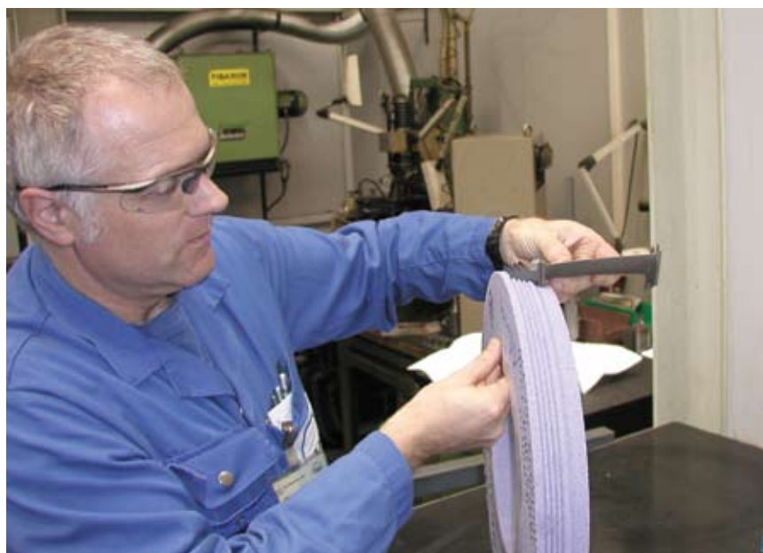
Roland Buchmann zeigt das Funktionsprinzip des Schleifprozesses «Tannenbaum-Profil»
