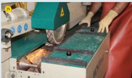
Nastro, 2510 siabite, grana 80, 30 mm x 1500 mm Finitura delle lamine degli sci.
