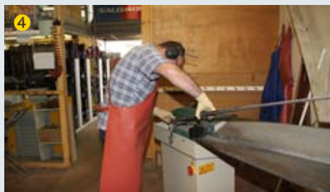
Nastro, 2515 siabite, grana 80, 30 mm x 1340 mm Finitura delle punte e delle code degli sci.
