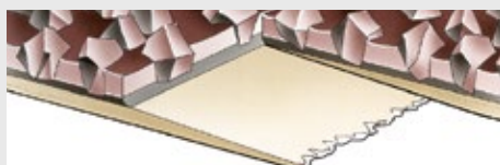
Joint à recouvrement sans enlèvement de grains
