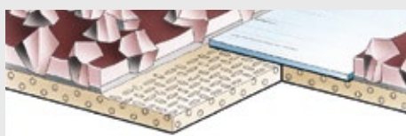
Typ 4: Gestossene Verbindung mit kornseitiger Spezialfolie
