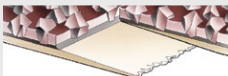
Typ 1: Überlappende Verbindung ohne Kornabschliff
