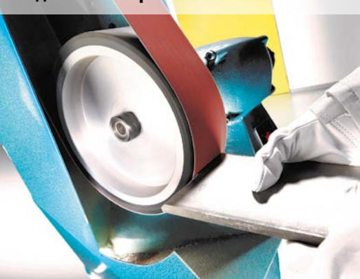
Подготовка сварного шва
