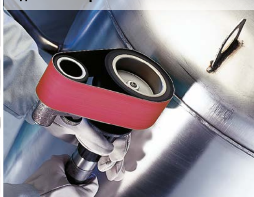
Удаление сварного шва
