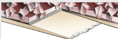
Typ 1: Giunzione sovrapposta senza molatura
