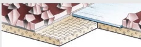
Typ 4: Giunzione testa a testa con pellicola speciale sul lato della grana
