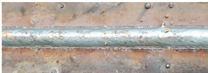
La méthode conventionnelle avec 3 disques fibre au zirconium sans le système X-LOCK
