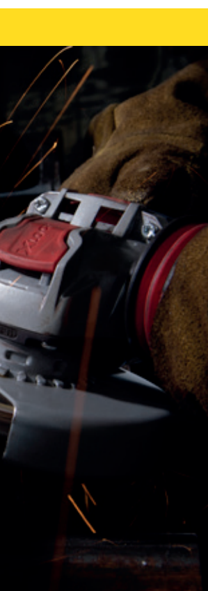
Arasage du cordon de soudure
